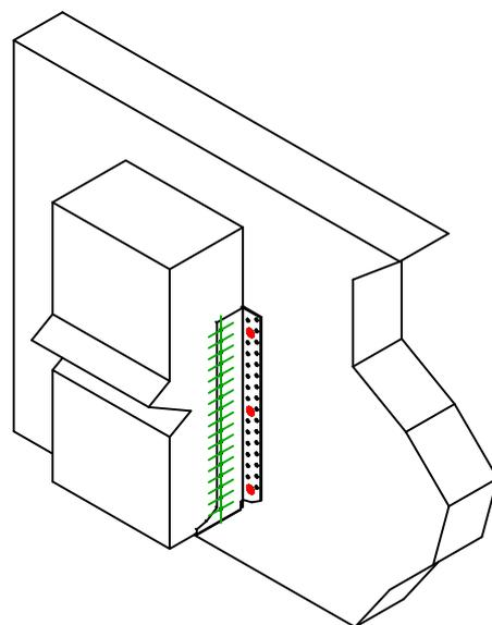
Spojovací prostředky na hlavním nosníku
