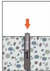
3. VAC Mörtelpatrone in das Bohrloch setzen.
