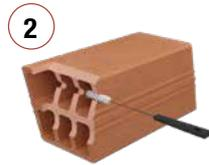
2. Bohrloch mit Bürste reinigen und ausblasen:
