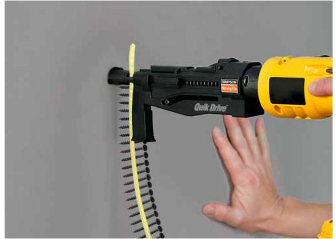
Montage einer Gipskartonplatte an Holzständerwerk mit DWC-Schnellbauschrauben
