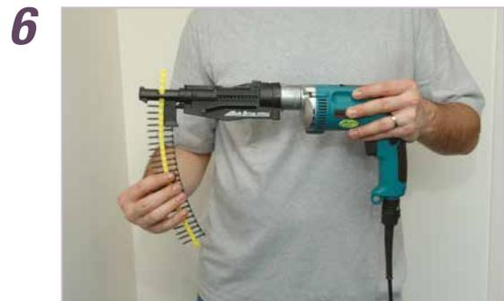
Setzen Sie den Schraubengurt (Spitze zuerst) in den Schraubervorsatz ein. Ihr Schnellbauschrauber ist einsatzbereit!
