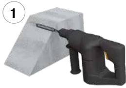
1. Bohrloch hammerbohrend bzw. drehbohrend für Mauerwerk erstellen. Durchmesser und Bohrtiefe beachten.
