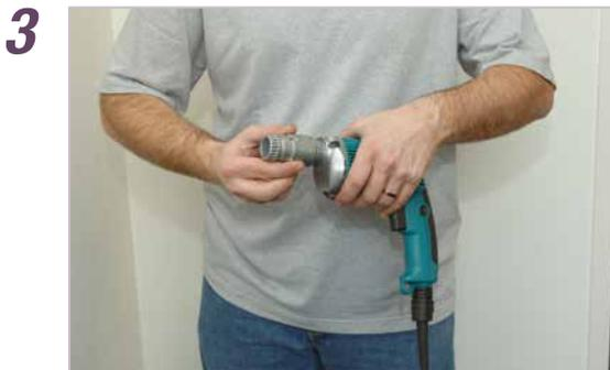
Montieren Sie den QD-Adapter auf den Schrauber.
