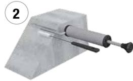
2. Bohrloch mit Bürste reinigen und ausblasen. Druckluft (6 bar) für Bohrungen  $\geq 10d$  oder  $> \varnothing 22 \text{ mm}$ : 4x ausblasen, 4x bürsten, 4x ausblasen.
