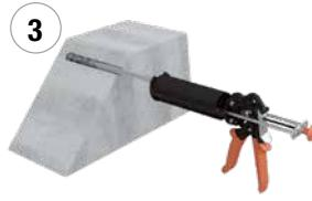
3. Vor dem Injizieren: Mörtel auspressen, bis dieser eine einheitliche Färbung aufweist. Mörtelvorlauf (min. 3 Hübe) verwerfen. Mörtel vom Bohrlochgrund aus hubweise injizieren, bis 2/3 des Bohrloches verfüllt sind.
