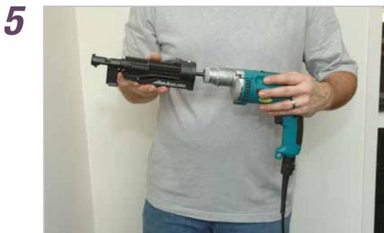
Stecken Sie den Schraubervorsatz auf den Adapter und lassen Sie ihn einrasten.
