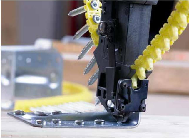
Montage eines ABR Winkelverbinders mit CSA-T Verbinderschrauben
