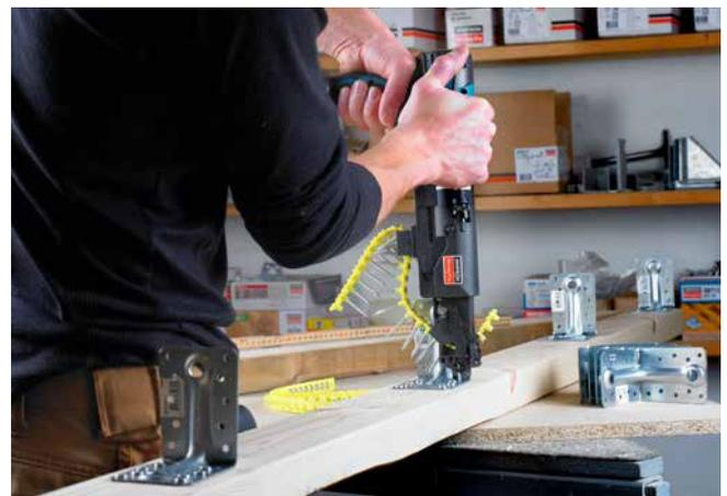
ABR Winkelverbinder befestigt mit CSA-T Verbinderschrauben – schnell und effektiv.
